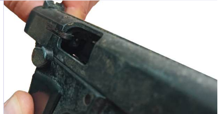
Sporni pištolj sa ručno povučenom udarnom iglom unazad
