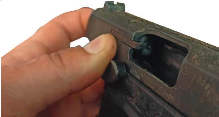
Sporni pištolj sa ručno potisnutom udarnom iglom
