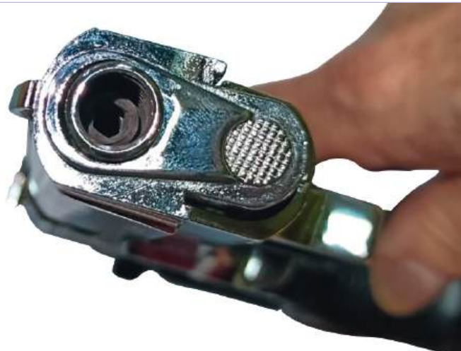
Sporni pištolj, navoj za montažu dodatka za ispaljivanje zvezdica, pogled u usta cevi
