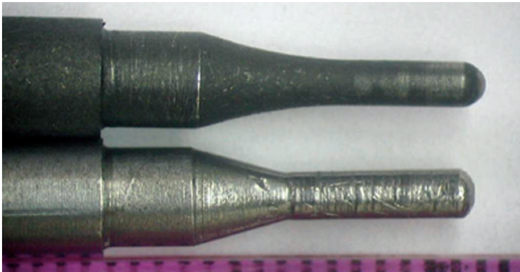
Слика 23. Упоредни снимак две ударне игле за пиштољ на којима се види разлика у начину израде и дужини (горња - оригинална, доња - неоригинална накнадно замењена)
