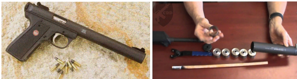
Слика 20. Интегрисани и монтажно- демонтажни пригушивач
