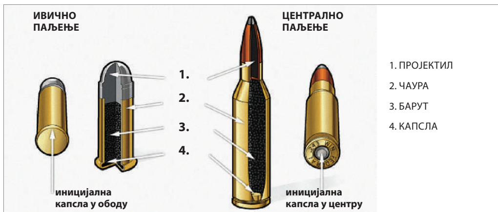
Слика 10. Метак са ивичним паљењем ( rifire ) и метак са централним паљењем ( centerfire )
